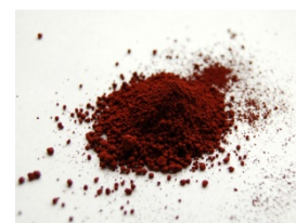
Figura 6.02. Óxido de Hierro(III) pulverizado.
